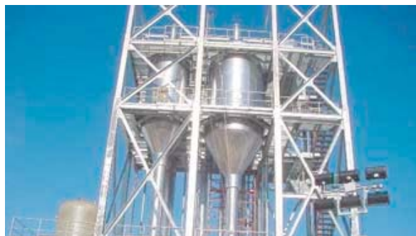
Figura 4.18. Imagen de evaporador al vacío.
