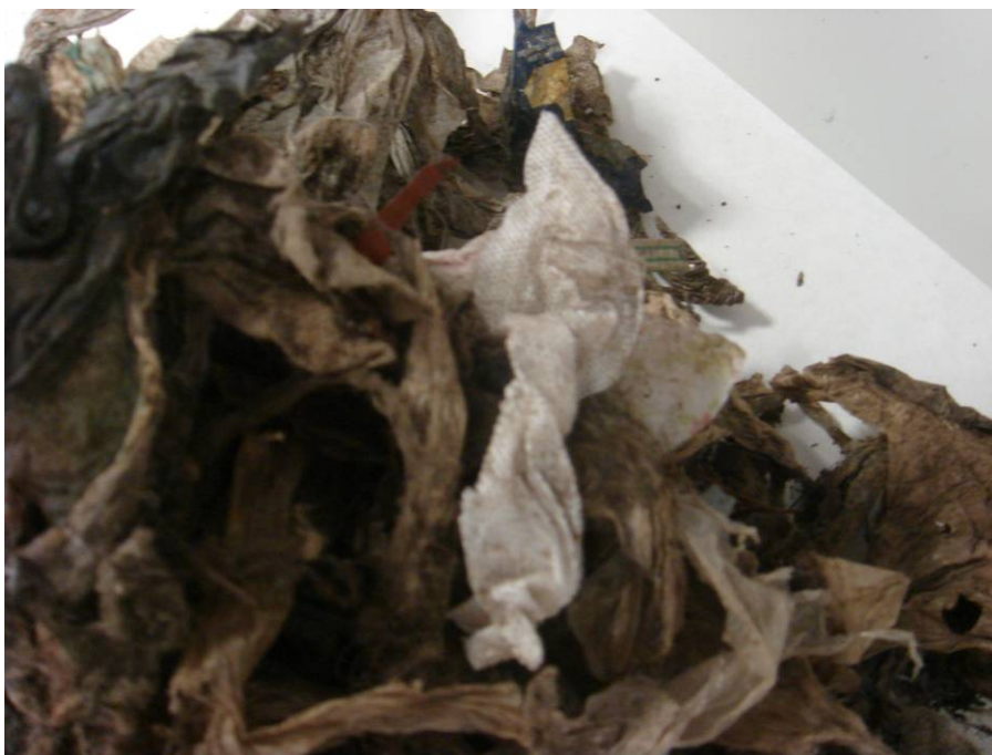
Imatge 19: Detall del rebuig del material reciclat procedent del garbellat de la pila amb bolquers.
