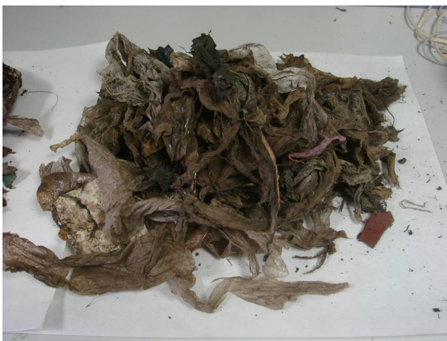
Imatge 18: Detall del rebuig del material recirculat procedent del garbellat de la pila amb bolquers.
