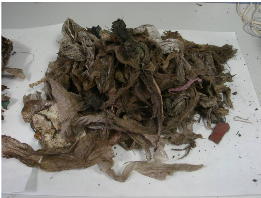
Figura 15. Detall del rebuig del material recirculat procedent del garbellat de la pila amb bolquers
