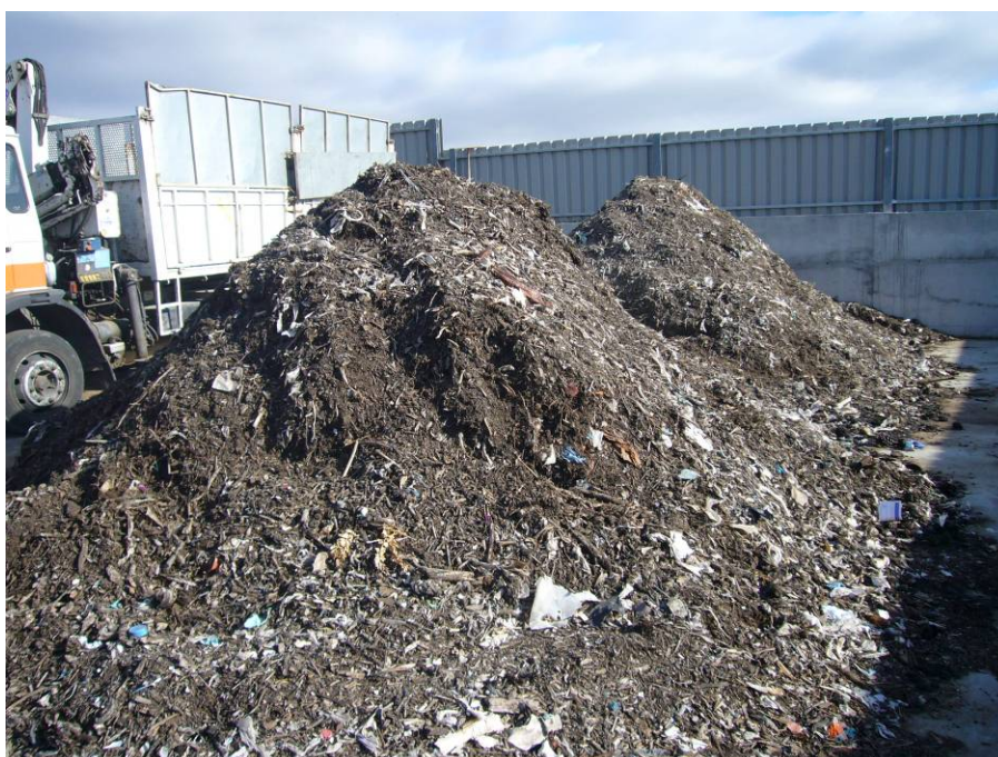
Figura 8. Imatge de les dues piles de maduració a la part final del procés (front: sense bolquers; darrere: amb bolquers)
