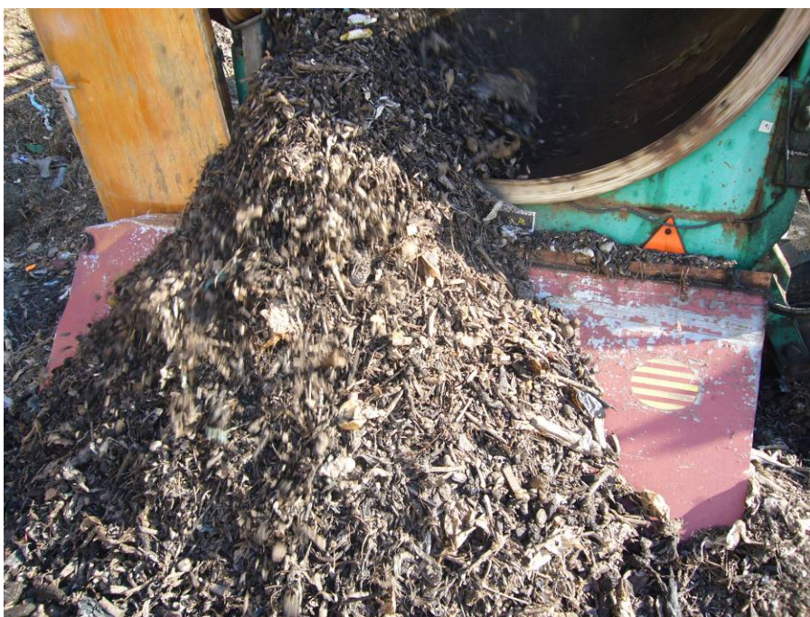
Imatge 16: Material recirculat procedent del garbellat de la pila sense bolquers.
