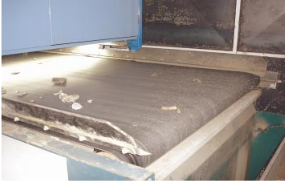
Màquina de visió artificial per separar els metalls continguts als residus banals
